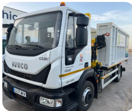
Camión Volquete con Plataforma y Grúa
